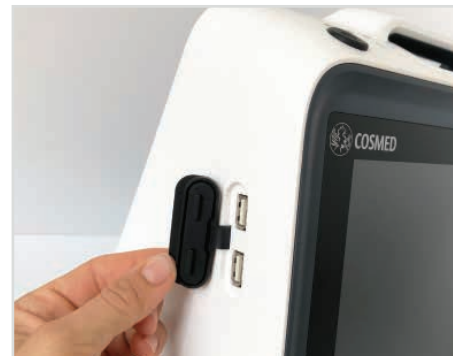
Los puertos USB laterales permiten una exportación de datos fácil para una gestión eficiente.
